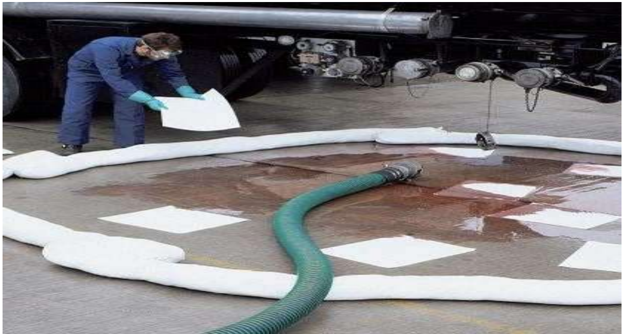
Hình 3.16. Mô tả Sử dụng phao quây dầu tấm thấm dầu để thấm hút dầu tràn
